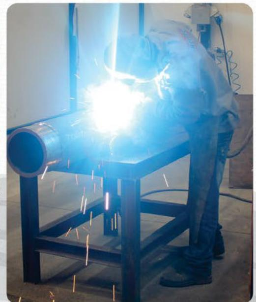
A soldagem MIG é o processo que é aplicado na união da maioria dos metais utilizados na indústria (aços, alumínio, aços inoxidáveis, cobre).
